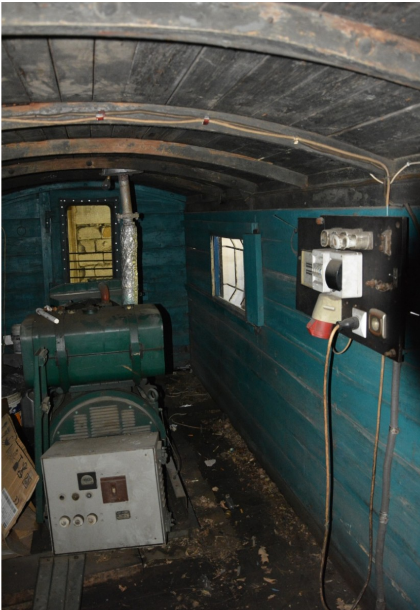
Zdj.14. Stan zachowania wnętrza wagonu – agregat - przed rozpoczęciem prac – 2023 rok
